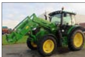
JOHN DEERE 6110R N° 127491 2017 - 110 cv - 945 h - AP - CommandArm - chargeur JD 623R - TLS - clim
