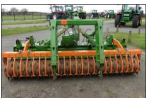
Herse AMAZONE CULTIMIX KX3000 N° 132024 2011 - 3 m - 20 dents - rouleau packer - relevage hydraulique 9 200€HT
