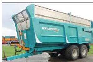
Benne ROLLAND RS6835 N° 101869 2011 - PTAC 24 T - réhausses 70 cm alu - report de charge 22 000€HT
